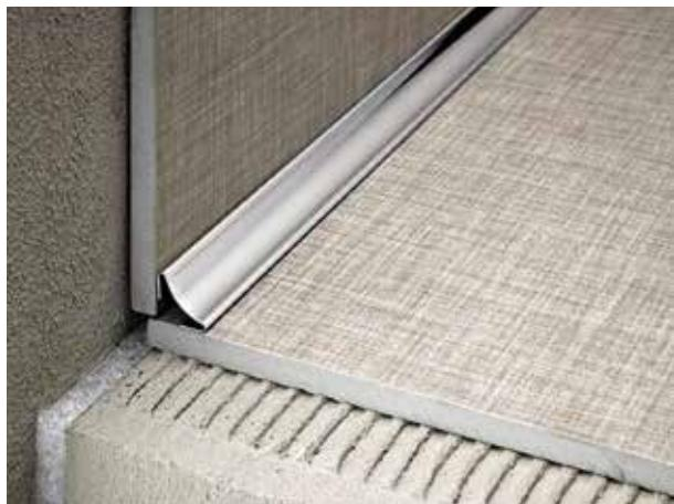
SANITEC SB15IL est un profilé à gorge en inox, avec fonction hygiénique indiqué pour l'industrie alimentaire, les bains publics et les cuisines. Il s'applique après pose. Grâce au rayon particulier de la courbe et aux caractéristiques de résistance du matériel utilisé, il garanti l'hygiène et la propreté des angles rentrants entre deux murs ou entre mur et sol.
